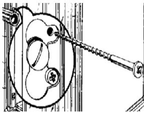
Schrauben beidseitig der Trennwand aus Profilen und Dübeln herausdrehen
