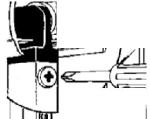
Eckverbinderkappe über Schraube demontieren
