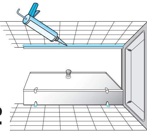
**Achtung!** Nur Sanitärsilikon verwenden. Bakterizid und Fungizid eingesetzt. Wärmefest entfetten!
